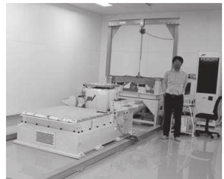
パレットに載せたまま揺れを測定できる大型振動試験機
