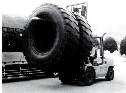
建設車輛用大型タイヤの搬出作業
